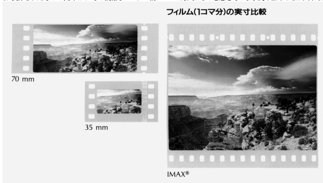
写真7 IMAXフィルムと他方式のサイズ比較
